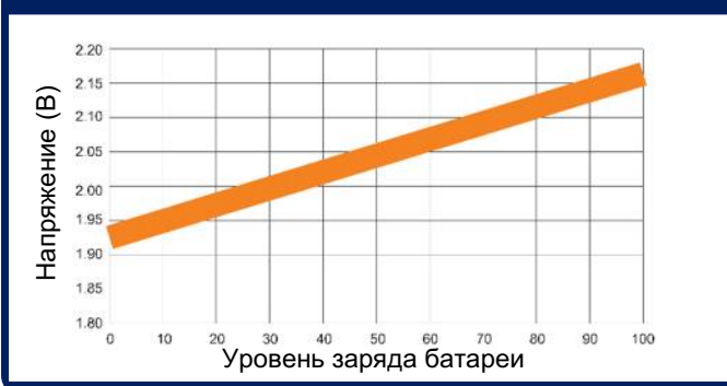
Зависимость напряжения от уровня заряда (20°C)
